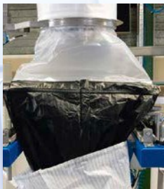
Containment-Folie in den Big-Bag In-Liner einlegen und fest verschweissen
