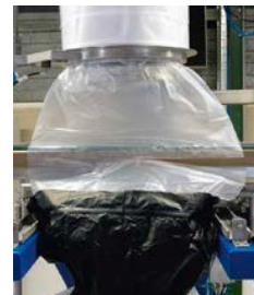
Containment-Folie verschweissen und mit Trenn-Schweissnaht abtrennen
