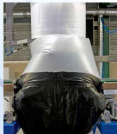
Schweissnaht mit N2-Druck von innen oder Manuell von aussen öffnen (peelen)
