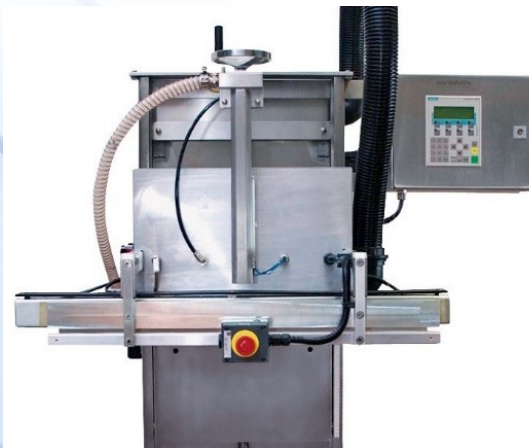
Schweissmaschine mit absenkbarer Lanze für die Kopfraumabsaugung.
