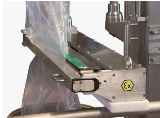
Geschlossene Schweiss-Schere während des Schweiss- und Trennvorganges
