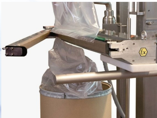
Ausführung als Trenn-Schweiss-Schere (linkes Bild) oder Schweiss-Schere (rechtes Bild)
