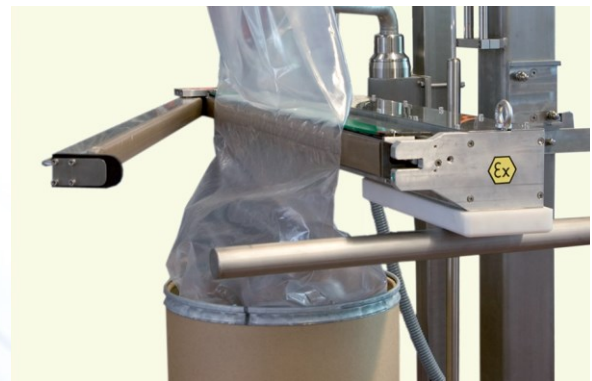
Ausführung als Trenn-Schweiss-Schere (linkes Bild) oder Schweiss-Schere (rechtes Bild)
