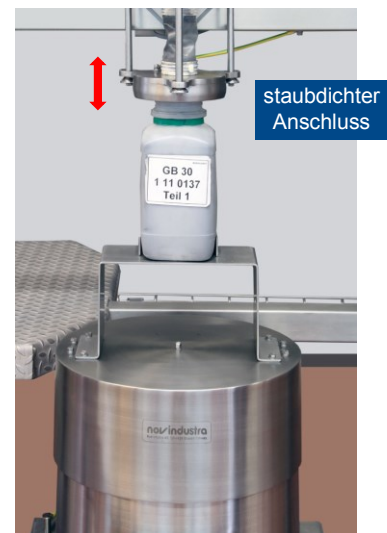
Anschluss des Produktbehälters an die Dosierrinne.
