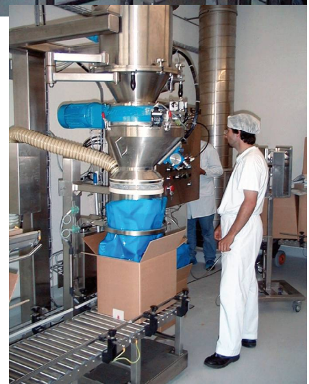
Abfüllstelle mit NOVI-DOS Dosiersystem
