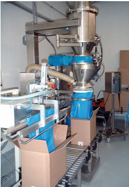
Abfüllstelle und Schweissmaschine
